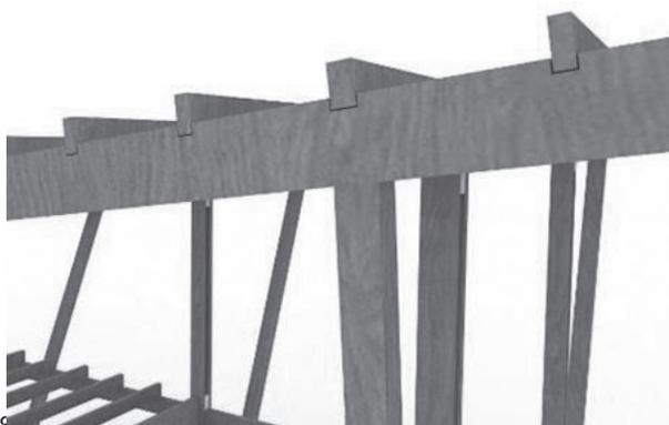
Fig. 3: Apoio das vigas secundárias. Fonte: dos autores
