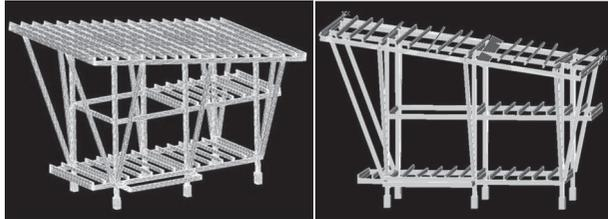
Figura 2. A: Estrutura modelada em elementos finitos. B: Deformação dos elementos da cobertura. Fonte: dos autores
