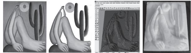
Fig. 02. Processo de modelagem tridimensional à partir de imagem bidimensional e modelo tátil final.
