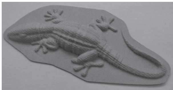
Fig. 01. Modelo tátil usinado na fresadora CNC em MDF.
