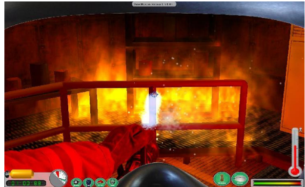
Figura 16. Captura de pantalla del simulador DCOS FireFighter, desarrollado sobre Delta3D [38]. Vista en primera persona, con HUDs informativos, por ejemplo, la temperatura ambiente, el tiempo transcurrido, etc..
