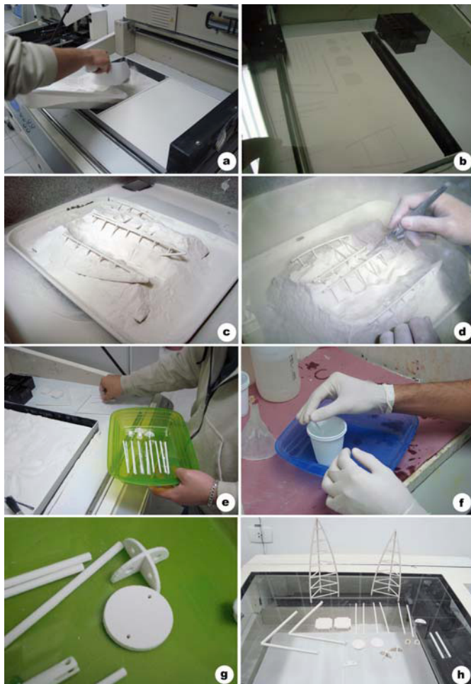
Figura 7. Experimento 2. Na foto 6a, o depósito de pó na máquina; Na foto 6b, uma das camadas sendo executada; Na foto 6c e 6d, o cuidadoso trabalho de remoção das peças de dentro do tanque com pó, Na foto 6e e 6f, a aplicação do binder, Na foto 6g e 6h, as peças prontas. Fonte: Autores, 2008.
