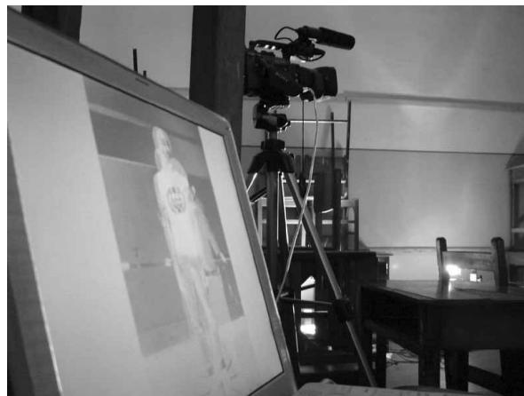
Figura 2: Detalhe do equipamento usado na montagem, câmera de vídeo conectada ao computador que faz o processamento das imagens captadas.
