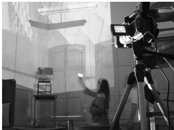
Figura 1: imagem do ambiente híbrido desenvolvido pela pesquisa, destaque para a câmera de vídeo que capta a imagem da pessoa interagindo com o espaço segurando o ponto de luz que no caso montado, funciona como espécie de guia para o computador executar os eventos culminando na interatividade com a projeção.
