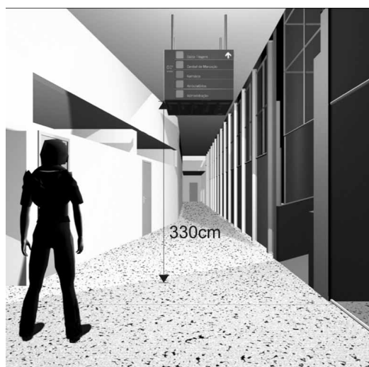
Figura 2: Instalação incorreta com 320cm
