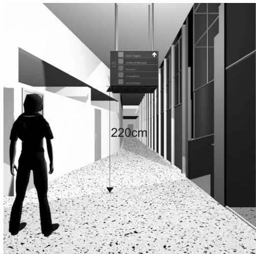
Figura 1: Display de sinalização, instalação correta com 220cm
