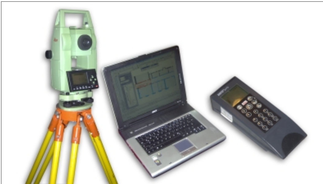
Abb. 4-1 Arbeitsmittel für das Bauaufnahmемodul – Tachymeter, Notebook und Laserdistanzmesser (v. li. n. re.)
