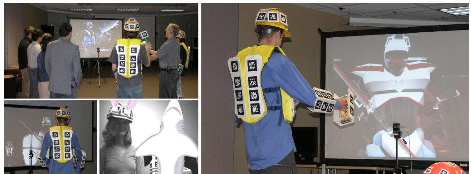
Abb. 5.3: Projekt „Magic Mirror“ - ARTag-Marker werden von einer Kamera getrackt, um Positions- und Orientierungsdaten von der realen in die virtuelle Welt zu übertragen [www6].
