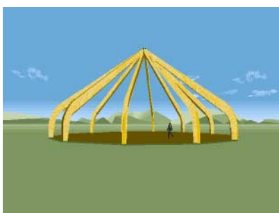
Figura 8 – Distribución Radial con Pórtico Curvo
