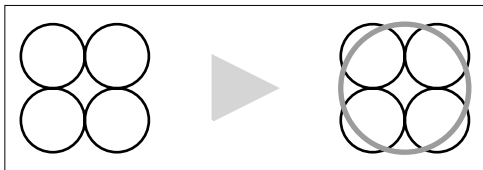
Bild 45 Klassifikationsmethoden äußern sich ganz allgemein im Datenraum dadurch, daß sie für eine Menge von Containern (Symptome) einen zusammenfassenden Container (Diagnose) suchen. Der Diagnose-Container umschließt die Symptom-Container räumlich.
