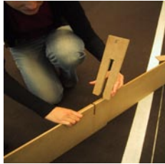
3-Achsfräse | MDF Slot-Verbindung
