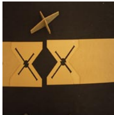
Pocket-Verbindung kombiniert mit Slot-Verbindung
